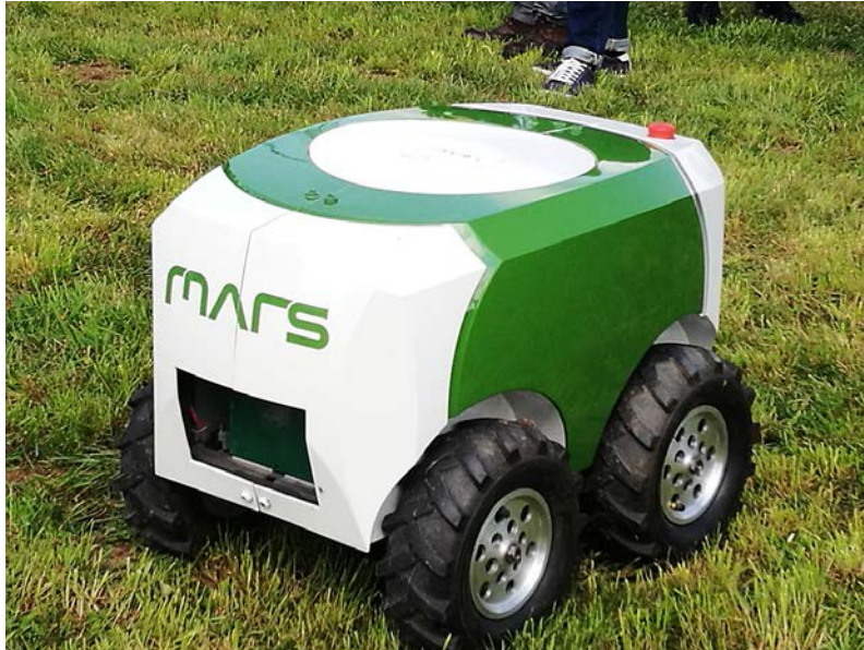
Foto 3. Robot para la siembra autónoma de precisión en maíz.
