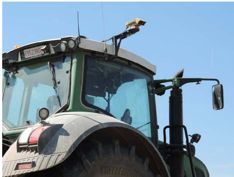
Foto 2. Tractor equipado con sistema óptico para la aplicación de dosis variables de fertilizante en tiempo real en función del vigor del cultivo.
